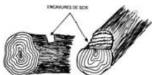
Les traits de scie ne peuvent être plus profonds que 2 cm, le gros bout ainsi endommagé doit être tronçonné. (résineux seulement)
